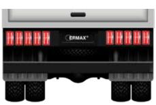
HINWEIS: Bei nur vertikaler Montage muss ein separater gesetzlicher Rückstrahler montiert werden
